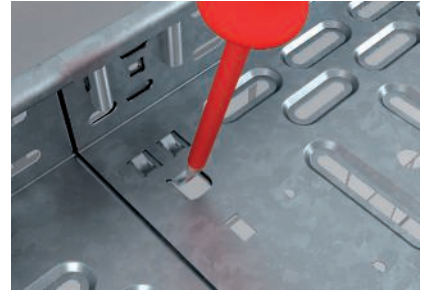
Csavarmentes illesztő kötés, csak a lemezfüleket kell lehajlítani.
