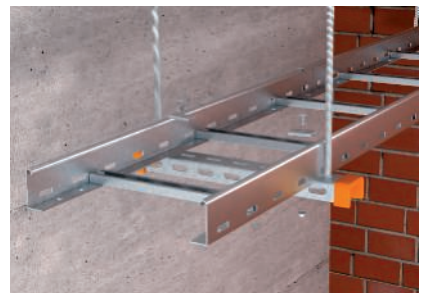
Szerelés keresztprofilra szorítókapoccsal, félgömbfejű csavarral és nagyméretű alátéttel.
