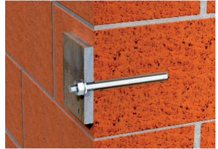
Horgonyrúd tömör téglában, szitahüvely nélkül.
